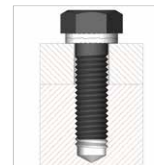
Tornillo hexagonal asegurado en un agujero ciego
