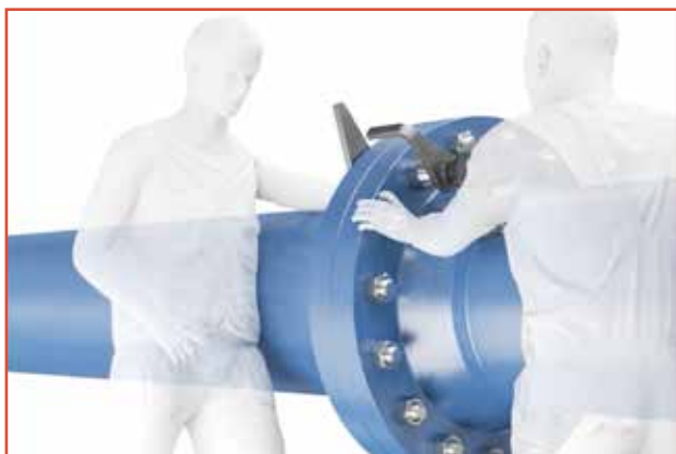
Montage mit Reaktionsarm: Gefahr von Verletzungen und Beschädigungen des Materials.
