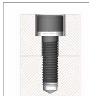
Zylinderschraube in Senkung gesichert
